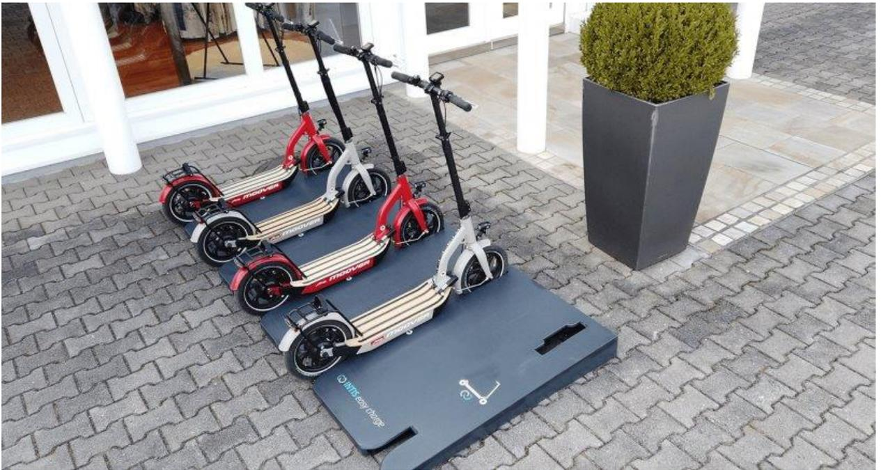
Рисунок 19 – Беспроводная зарядка EasyCharge
