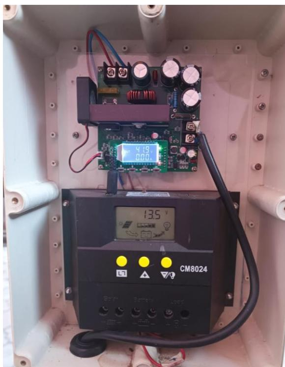
Рисунок 6 – Контроллер заряда зарядной станции для электросамочатов
